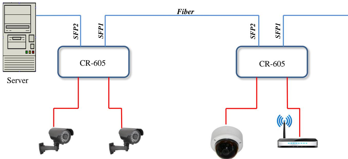
На рисунке изображены два коммутатора CR605, подключенные по цепочке к центральному серверу. Коммутаторы обеспечивают коннективность через оптоволокно с тремя камерами и Wi-Fi точкой доступа.
