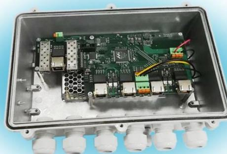
**CR-603 представляет собой 7 портовый коммутатор Ethernet в защищенном корпусе, рассчитанный на работу в промышленном диапазоне температур, с поддержкой технологии POE+, поддержкой оптических модулей SFP. Коммутатор обеспечивает подключение конечных устройств по стандарту 1000/100base-T к волоконно-оптическим линиям со скоростью 1000 или 100 мбит/с. Изделие обеспечивает питание внешних устройств по стандартам PoE 802.3at, 802.3af.**
