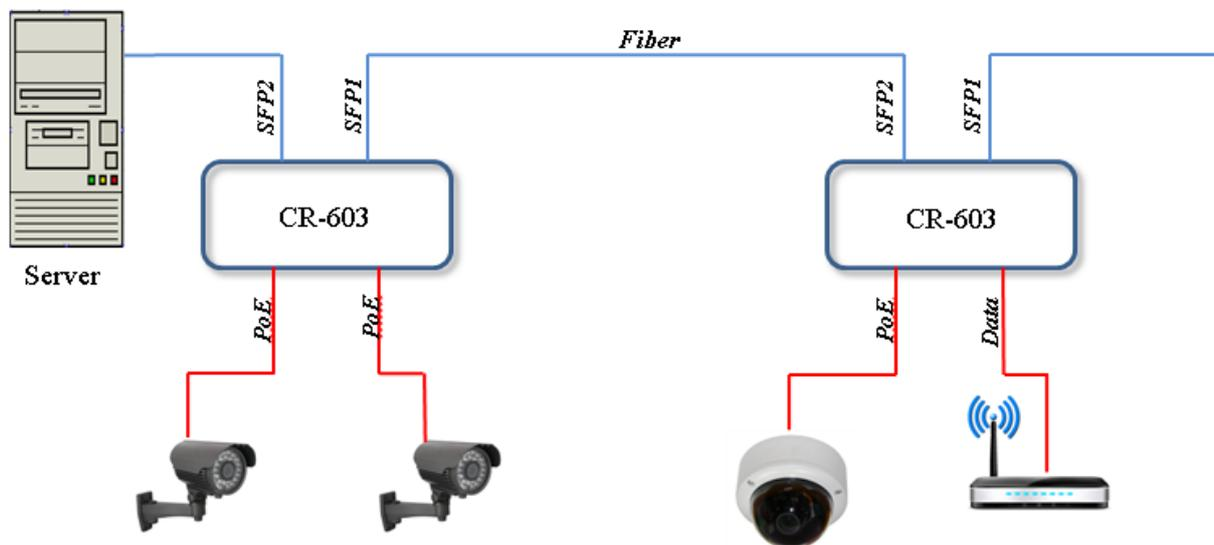
Коммутатор позволяет подключать внешние устройства как по топологии «точка-точка», так и по цепочке. Тем самым достигается покрытие практически неограниченной территории. Изделие может использоваться при организации уличных сетей связи для видеонаблюдения, СКУД, ОПС, подключения к Internet.
