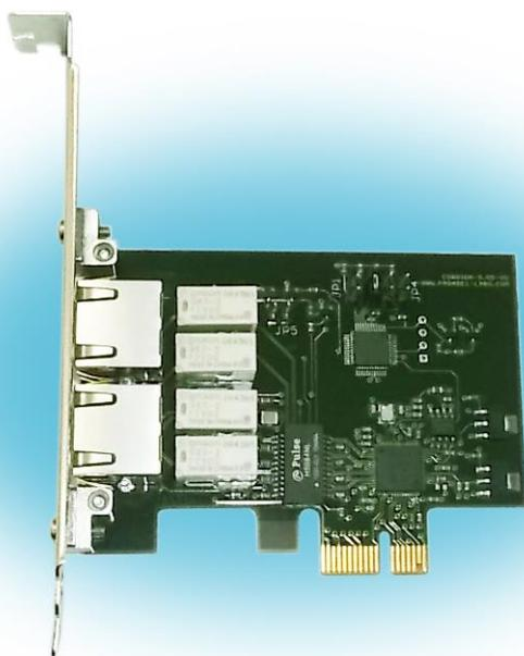
LAN адаптер CR-505 представляет собой одноканальный Ethernet адаптер с одним основным и одним обводным (байпас) портом. Переключение основного порта на байпас порт (bypass режим) происходит автоматически при выключении питания сервера или при срабатывании сторожевого таймера. Адаптер CR-505 может быть использован в системах горячего резерва серверов - Web, баз данных, терминальных.
