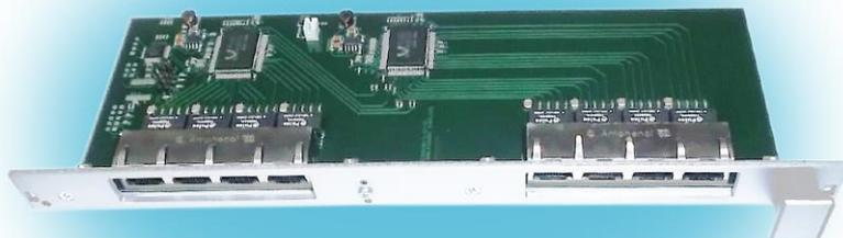
CR-502 представляет собой коммутатор Ethernet в формате Еврокарты высотой 6U (в соответствии с механическими стандартами IEEE 1101.1 и IEEE 1101.11). Устройство имеет 8 портов Gigabit Ethernet и может использоваться в нескольких режимах - как неуправляемый коммутатор общего назначения, коммутатор с функциями VLAN, или перехватчик трафика (Ethernet tap).
