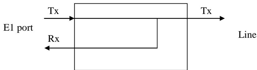
**Test/Loopback/RLOOP** – включить удаленный шлейф на порту E1
