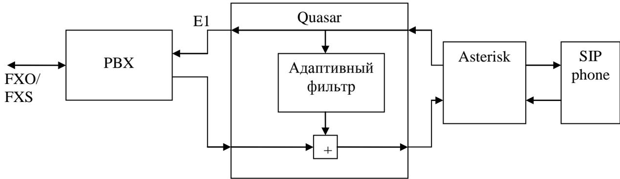
Рис. 1. Структура модуля эхоподавления
