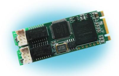
Интерфейсная карта Quasar-M2 предназначена для подключения 2 интерфейсов E1 к компьютерам под управлением софт ATC Asterisk. Адаптер выполнен в виде платы формата PCI-express 2260 M2.
