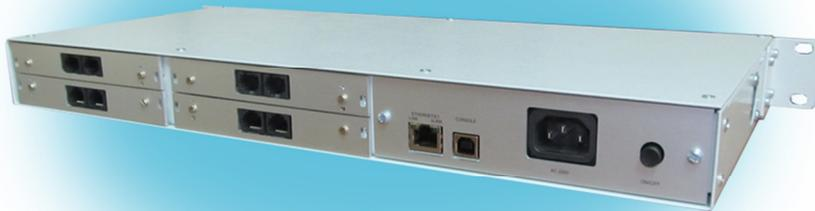
Asteroid-1UT предназначен для подключения телефонных линий и GSM каналов к Asterisk/Freeswitch. Связь с сервером осуществляется через порт Ethernet, с использованием протокола TDMoE. Изделие поставляется в виде шасси на 4 слота и комплекта вставных модулей.
