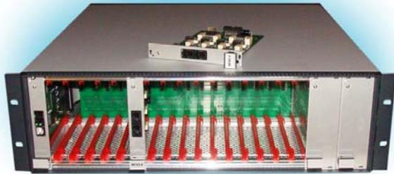
ASTEROID2-MT16 предназначен для подключения телефонных абонентов (линий) к IP АТС Asterisk/Freeswitch. Устройство позволяет подключать до 128 телефонных портов FXS/FXO и до 32 портов GSM. Подключение к IP АТС осуществляется через сетевой интерфейс Ethernet по протоколу TDMoE. Поддержка TDMoE в IP АТС реализуется через программный интерфейс DAHDI.
