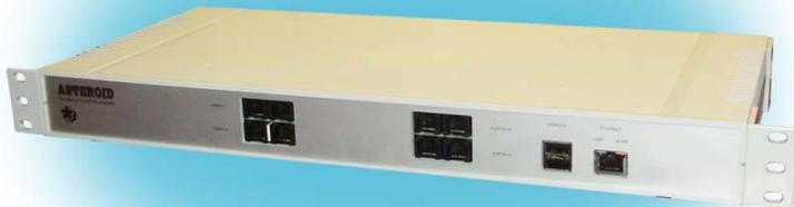
Asteroid может использоваться для подключения телефонных линий и GSM каналов к традиционной АТС или к Asterisk/Freeswitch. Подключение к традиционной АТС осуществляется через порт E1. Подключение к Asterisk/Freeswitch осуществляется через порт Ethernet, с использованием протокола TDMoE.
